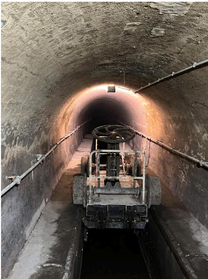
L'ENVIRONNEMENT CONFINÉ, CORROSIF ET HUMIDE DES ÉGOUTS REND L'USAGE DE MOTEURS À COMBUSTION OU ÉLECTRIQUES « INENVISAGEABLE ». LE WAGON-VANNE, DONT LE POIDS PEUT ALLER JUSQU'À 5 TONNES, EST DONC NON MOTORISÉ ET DOIT. EN BOUT DE COURSE, ÊTRE HALÉ VERS SON POINT DE DÉPART PAR LES ÉGOUTIERS.
